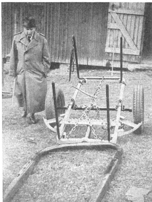
Fig. 3. Gummihjulskärria för kastved och kolved. (Konstruktion: Värmlands Skogsarbetsstudier.)
