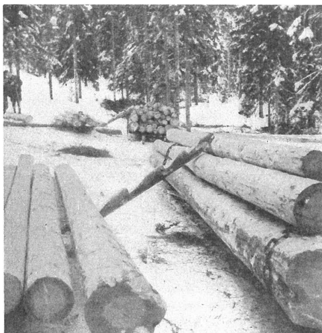
Fig. 6. Lastning av getdöning med hjälp av lastknekt.
