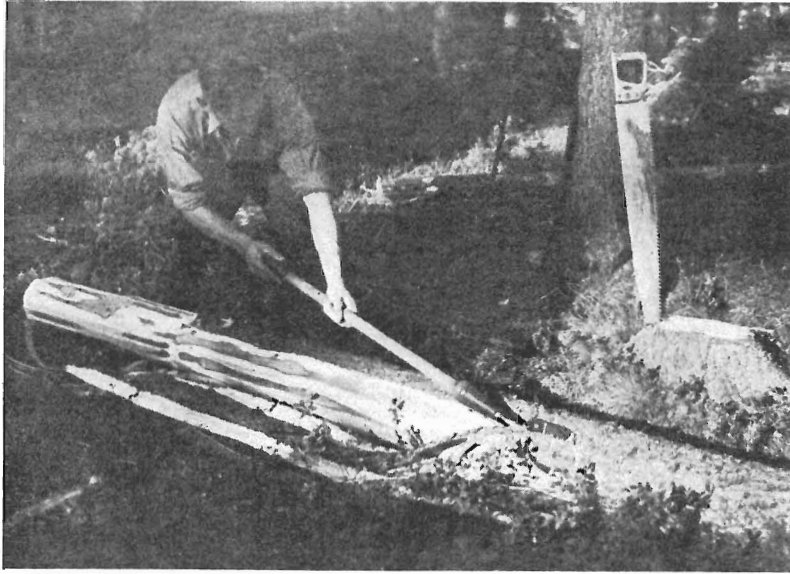
Fig. 140. Korrekt arbetssätt vid barkning.
