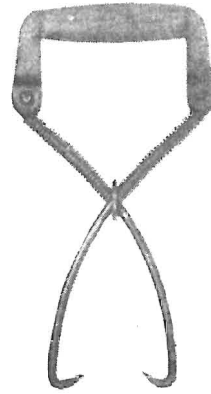
Fig. 48. Timmersax med hopfjädrande skänklar, s. k. Ludvika-sax.
