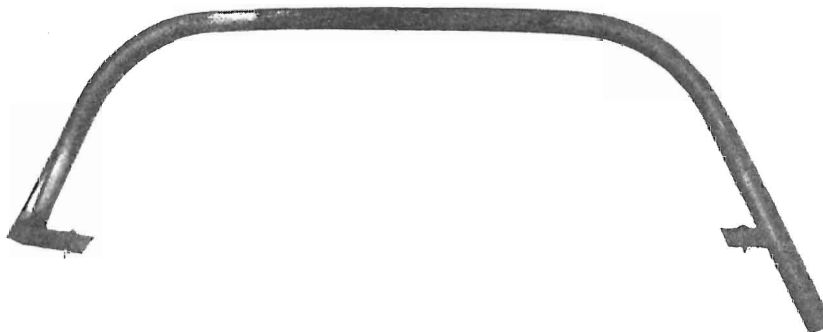
Fig. 36. Sågbåge med Martin-fästen.
