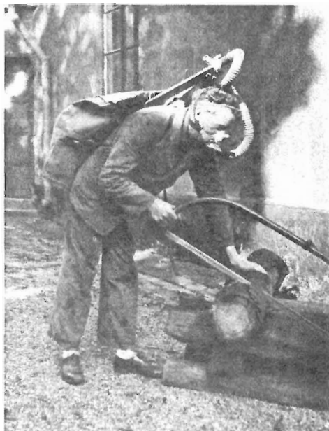
Fig. 108. Energimätning vid sågning enligt Douglas-Haldanes säckmetod.
