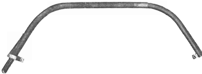
Fig. 35. Sågbåge med inskjutbart underdrag.
